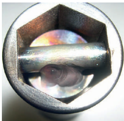
↑ Examen macrographique d'une soudure barrette/chapeau réalisée en eau borée.
